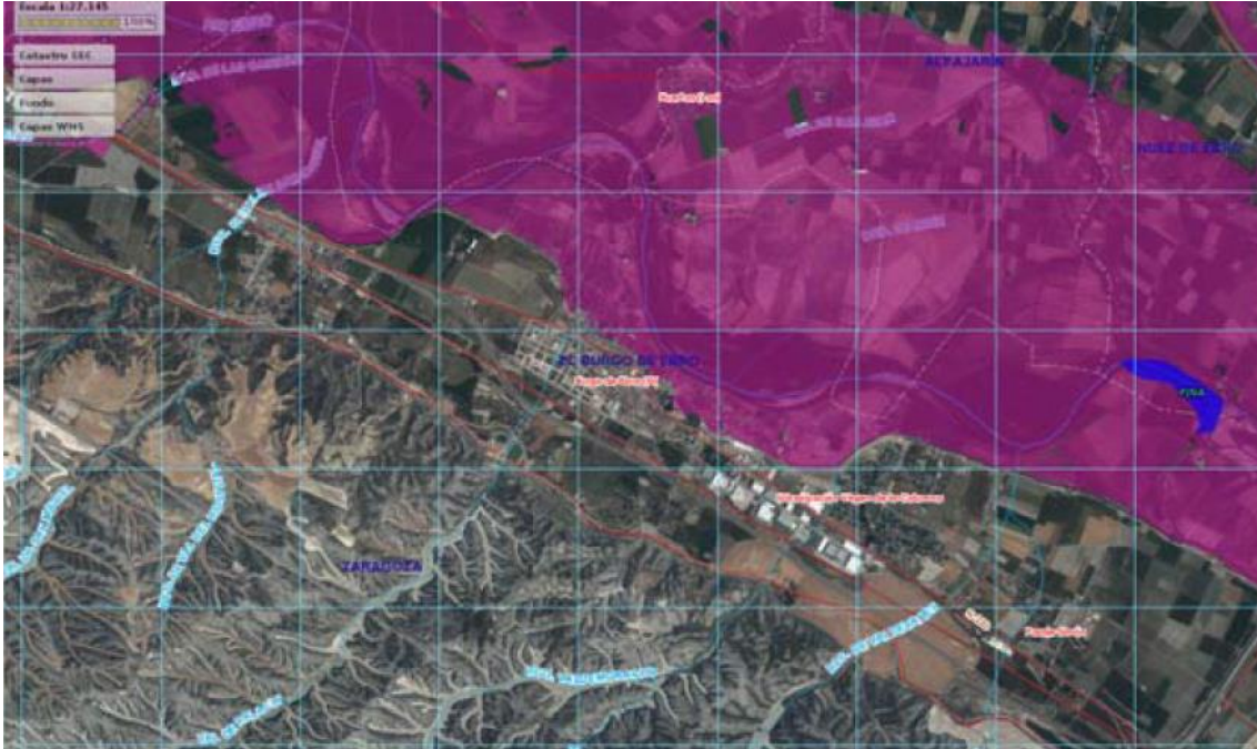
SUPERPOSICIÓN DE ORTOFOTO Y ÁREA DE INUNDACIÓN DEL RÍO CON UN PERIODO DE RETORNO DE 50 AÑOS DE AVENIDA. FUENTE. CONFEDERACIÓN HIDROGRÁFICA DEL EBRO.
